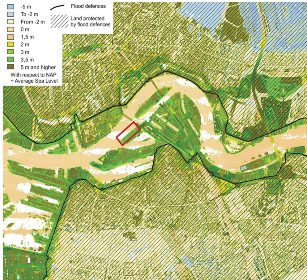
Figur 3.6 Højden af terrænoverfladen i forhold til det normale havniveau (NAP) for den del af Rotterdam, der omgiver Nieuwe Maas-floden. Områder beskyttet mod oversvømmelser er vist med skravering (datakilde Rijkswaterstaat). Området i det røde felt vises i figur 3.7.
