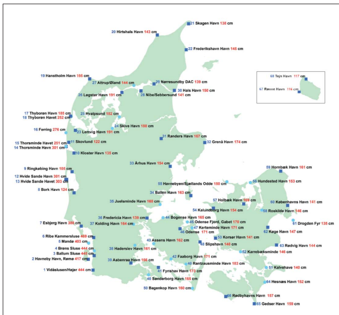
Figur 2-1: 50 års middeltidshændelser fra Højvandsstatistikker 2012 /1/. 50-årsvandstanden er angivet med rødt. Mørkeblåt mærke angiver gode statistikker, og lyseblåt mærke angiver mindre gode statistikker baseret på korte tidsserier (typisk < 15 år) og/eller serier med lav datakvalitet.
